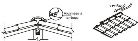
Para que o sistema funcione, é necessário que haja no mínimo duas telhas de ventilação alinhadas para cada vinte metros quadrados de telhado.
